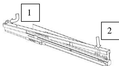
Posizionare i supporti in plastica (B) e avvitare la vite
